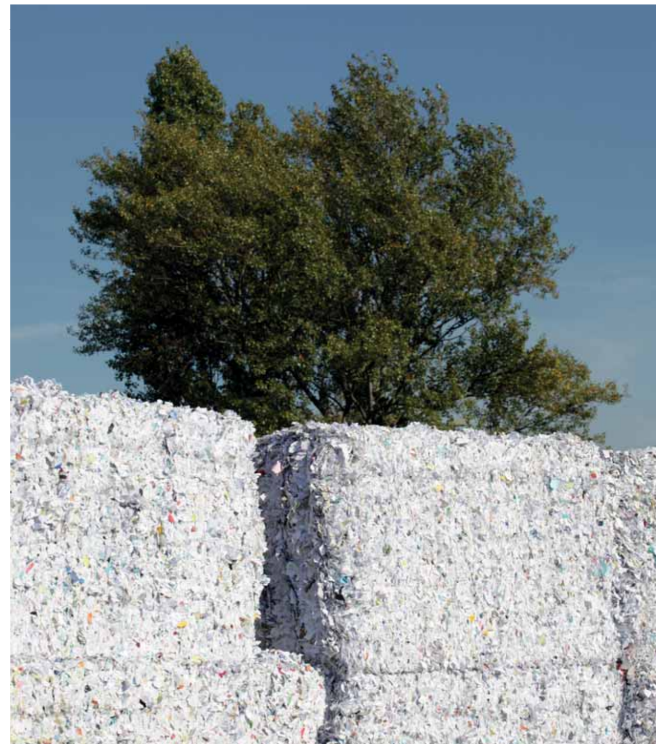
Une fois compactées, les différentes qualités de papier ressortent en balles d'un mètre cube environ, pesant chacune près de 900 kg.
